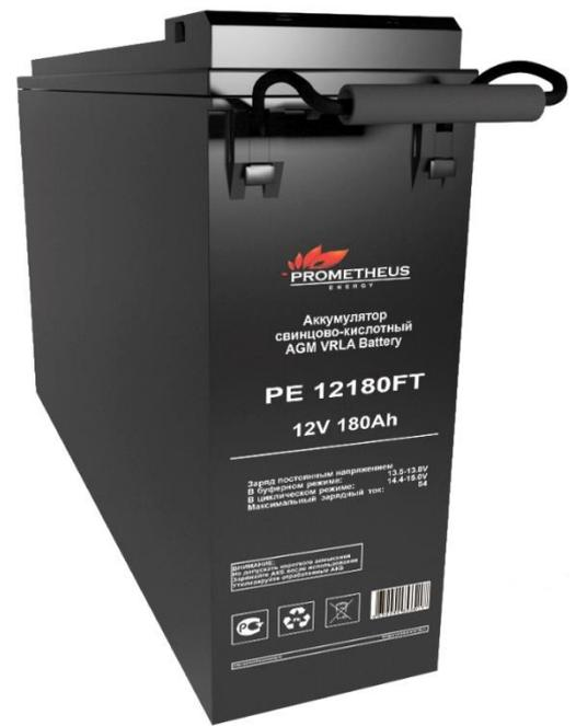
Свинцово-кислотные аккумуляторы **Prometheus Energy** серии FT изготовлены по технологии с абсорбированным электролитом (AGM). Конструкция корпуса оптимизирована для установки в 19" и 23" шкафы и стойки. Фронтальное расположение клемм обеспечивает удобство монтажа и контрольных замеров. Оптимальны для систем питания операторов мобильной связи.
